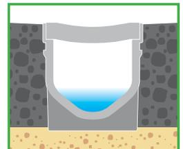
1. Creuser une tranchée assez profonde pour prévoir un lit de sable de 2 po (5 cm) et assez large pour recevoir 4 po (10 cm) de remplissage de béton de chaque côté.
